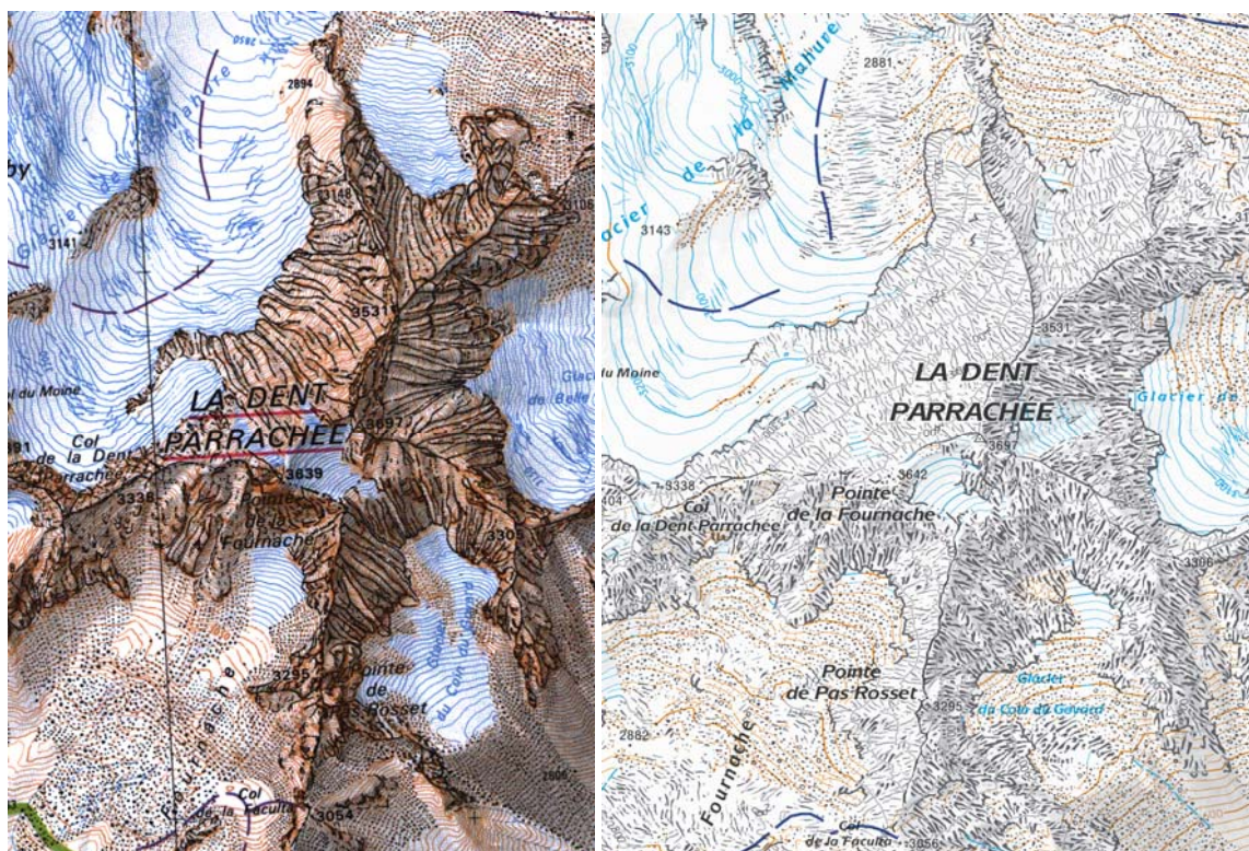
a) Ancienne carte dessinée manuellement b) Nouvelle carte obtenue automatiquement Figure 4 : Comparaison de représentation du relief en haute montagne sur la feuille de Modane
