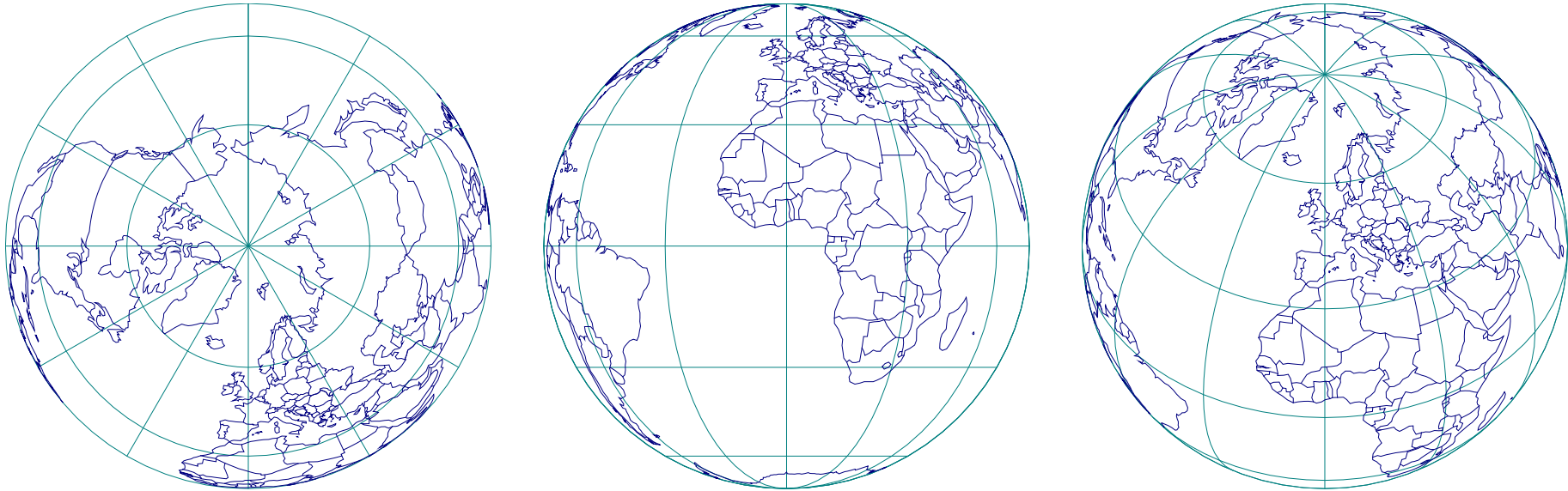
Figura 9.8 - La proiezione ortografica nel suo aspetto normale (a), trasverso (b) e obliquo (c).
