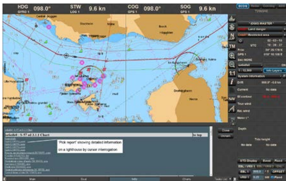
11.7. ábra Példa egy ECDIS-ben használt elektronikus hajózási térképre – Lilla Vartan-csatorna Stockholm közelében, Svédország Forrás: Transas.
