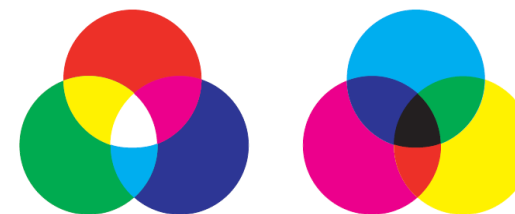
Figura 13.2 Apresenta a cor aditiva à esquerda e a cor subtrativa à direita. Observe que o amarelo da cor aditiva é uma mistura de vermelho e verde e que o verde da cor subtrativa é uma mistura de azul e amarelo.
